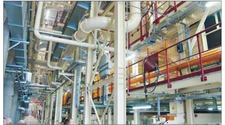
Streusystem von CMC Texpan mit „Ecoformer SL“-Köpfen für die Deckschichten
