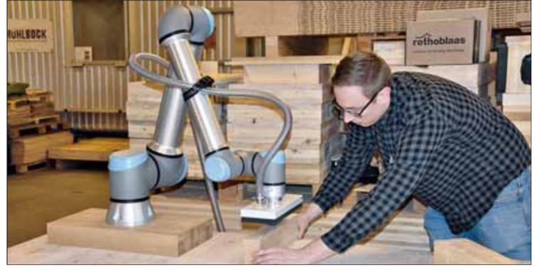
Zusammenarbeit zwischen Mensch (im Bild Birger Bartuska, wissenschaftlicher Mitarbeiter für Holzwerkstoffe und digitale Transformation bei Wood K Plus) und Roboter, einem „Cobot“.
