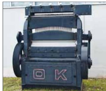
Anfang der 1950er-Jahre entwickelte Otto Kreibaum das Strangpressverfahren zur Herstellung von Spanplatten. Dabei werden Späne kontinuierlich in einen senkrechten Pressenschacht gestopft. Im Bild eine Original-„OK“-Presse, die auf dem Rauch-Gelände an die Anfänge erinnert.
