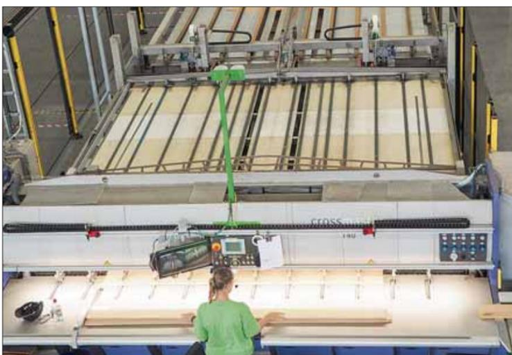
Mitarbeiterin an einer Querschnittsmaschine
