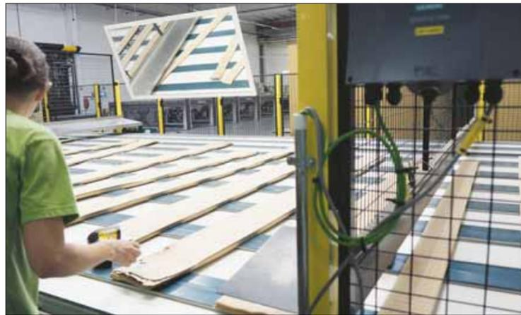
Eingangskontrolle der Rohfurnierpakete in Menen: Eine Mitarbeiterin markiert die Pakete mit Barcodes und speist diese in das System ein (links), den Rest übernimmt ein Scanner (rechts). Die Bilder des Scanners werden nicht nur zur Qualitätskontrolle verarbeitet, sondern auch dazu verwendet, das Furnier virtuell zu fügen oder Visualisierungen zu erstellen. Damit bekommen Kunden aus der Ferne ein Bild vom tatsächlichen Aussehen des angebotenen Furniers. Fotos: Steckel
