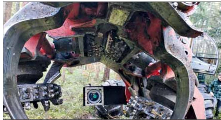
Ein am Vollernter integriertes Kamerasystem nimmt die Schnittflächen von Baumstämmen auf und generiert daraus einen „Fingerprint-Code“. Mit einer erneuten Bildaufnahme kann der Baumstamm später anhand des Codes eindeutig identifiziert werden. Fotos: Christoph Eberz/IPM
